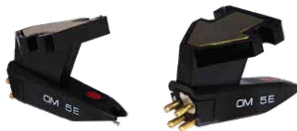
OM 5E verfügt über einen elliptischen Schliff, der eine ausgewogene und verzerrungsfreie Wiedergabe ermöglicht. Elliptische Diamanten sind aufgrund ihrer konturierten Form in der Lage, den Rillenschwingungen genauer zu folgen als kugelförmige Diamanten. Dies führt zu einem besseren Tracking und weniger Verzerrungen
